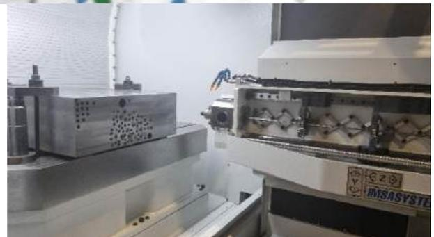
Die MF 1200 D ist eine CNC-Maschine mit 4/5 Achsen für das Tiefbohren mit Einlippenbohrern in Werkstücken bis zu 4 Tonnen. Störkreis 1.250 mm, Tischbelastung 4.000 kg. Die MF 1200 D kann mit einem festen Standardtisch (4 CNC-Achsen) oder einem optionalen Drehtisch (5 CNC-Achsen) ausgestattet werden.
