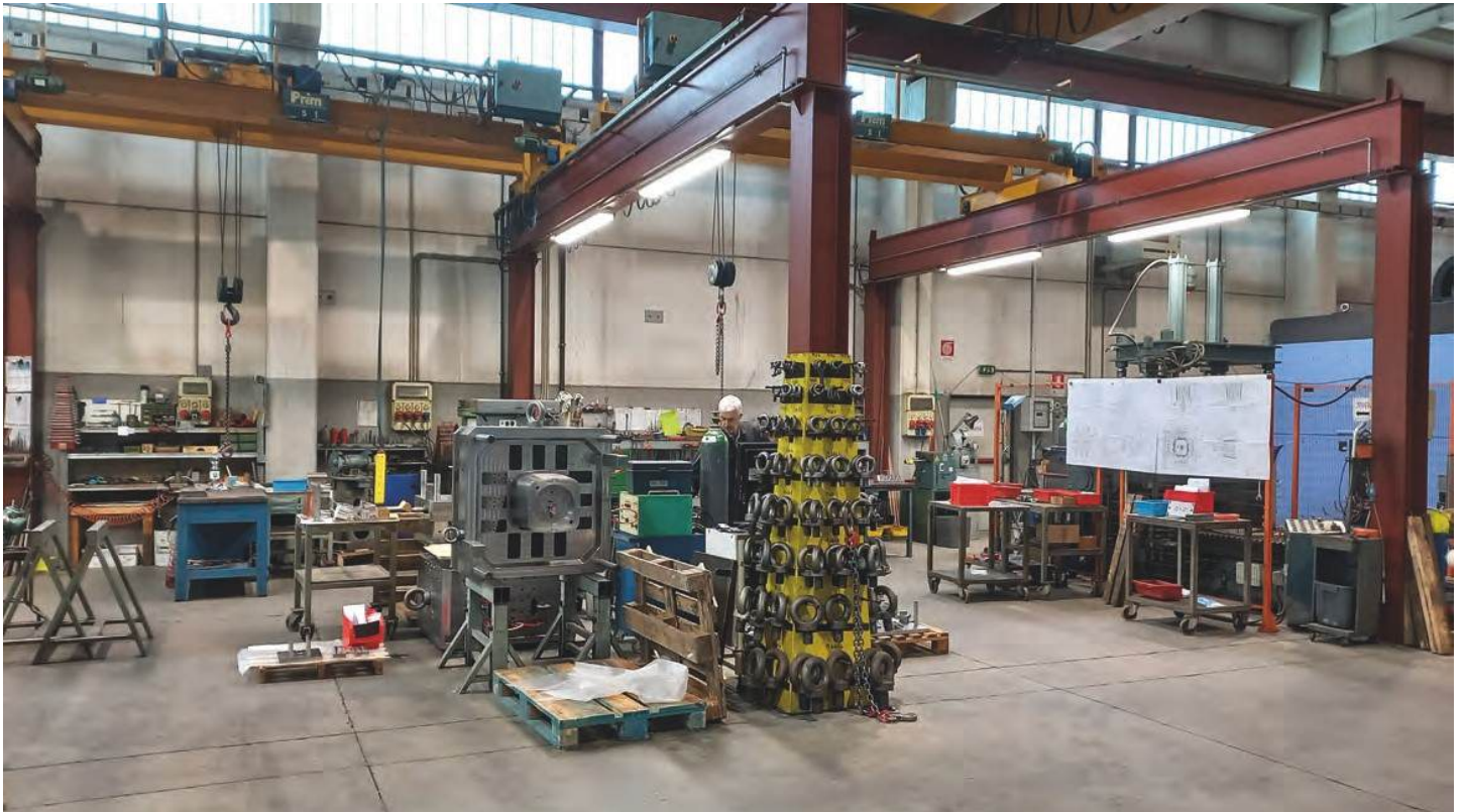
Die Montageabteilung besteht aus drei Stationen, die jeweils von einem eigenen Brückenkran bedient werden, und somit autonom und unabhängig von den anderen Produktionsabteilungen arbeiten können
