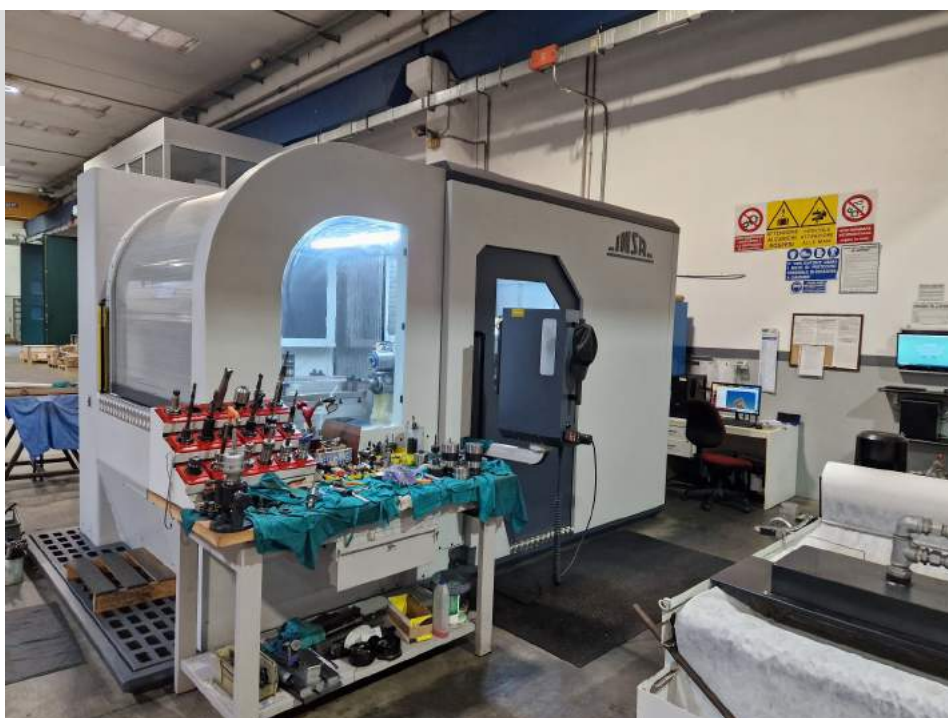
Machine de forage profond et fraisage MF1000/2C installée chez Gruppo Ideal Stampi
