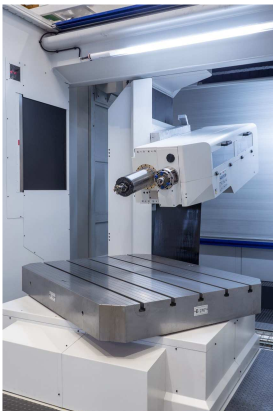
||| Die Doppelschwenkbearbeitung wird durch die Kombination von Tischdrehung und Schwenken der Bearbeitungseinheit durchgeführt.
