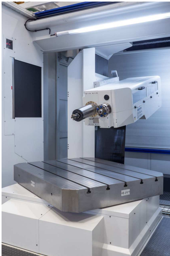
||| L'usinage à double inclinaison est réalisé en combinant la rotation de la table et l'inclinaison de l'unité de travail.
